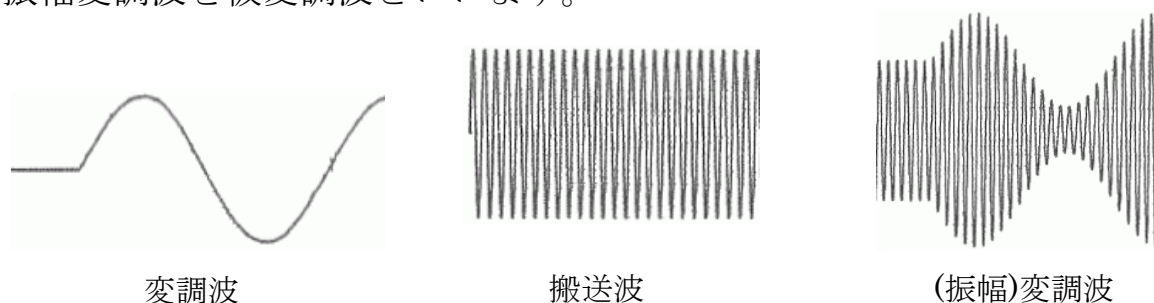
図3 振幅変調波を作る様子
