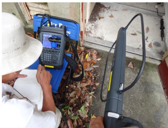
写真1 高感度レシーバーPR100 による測定
